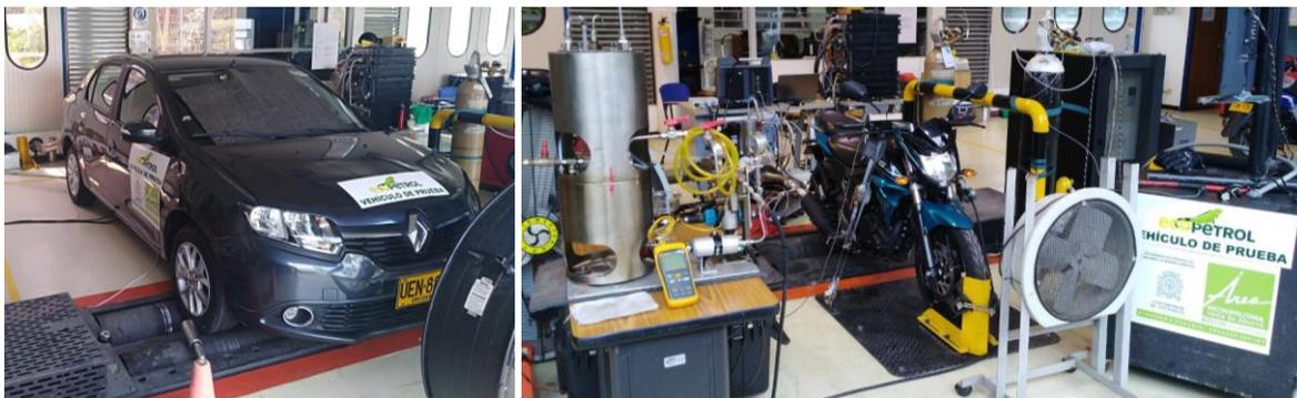
Figura 2.2. Determinación experimental de los FE en banco de chasis dinamométrico. Izq.: vehículo liviano. Der.: motocicleta
